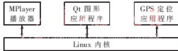
图 4 嵌入式 Linux 内核与应用程序示意图
