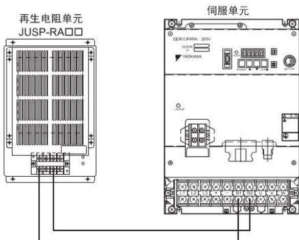
（注）请在伺服单元的 B1-B2 之间连接外接再生电阻单元。
