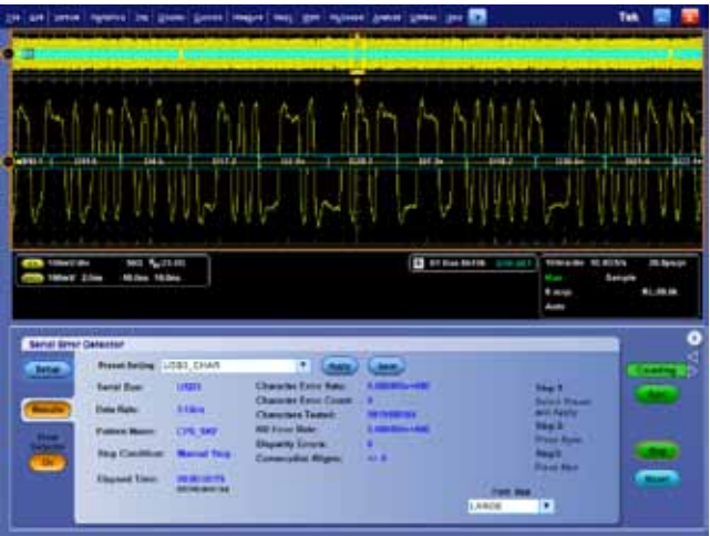
使用泰克串行错误检测器测试 CP0 一致性码型
