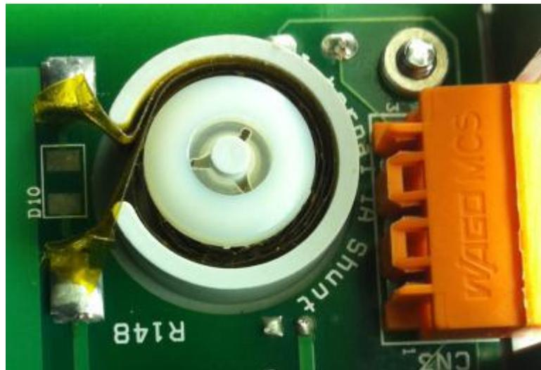
PA4000采用了创新的螺旋分流设计,在大范围的输入电流范围,环境温度,波峰因素,和其他变量条件下确保线性稳定度。这个专利设计优于其他公司采用的并联技术,在今天大动态范围输入的功率转换技术下,提供了高精度,高稳定性测量。螺旋结构不仅最大限度地减少杂散电感(最佳的高频性能),也提供了高过载能力和提高热稳定性。
