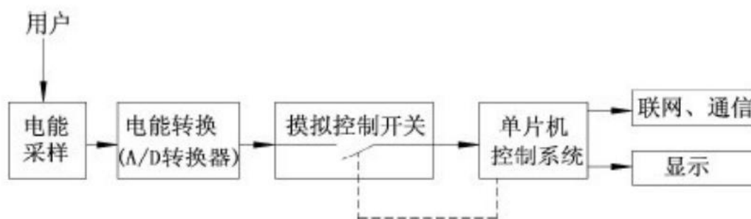
图 1.1 智能电表工作原理
