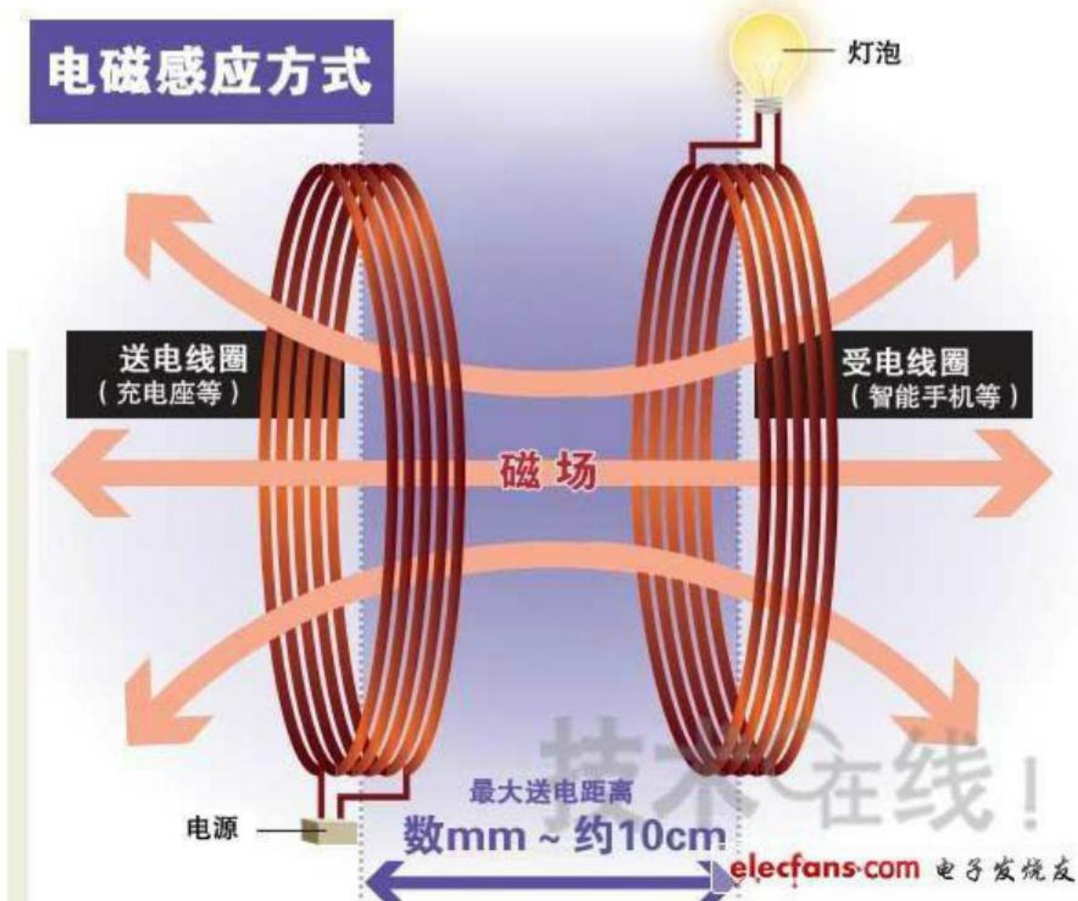
无线充电方式包括“磁共振”及“电波接收”等多种方式，Qi 采用的是“电磁感应方式”。通过实现标准化，只要是带有 Qi 标志的产品，无论是哪家厂商的哪款机型均可充电。
