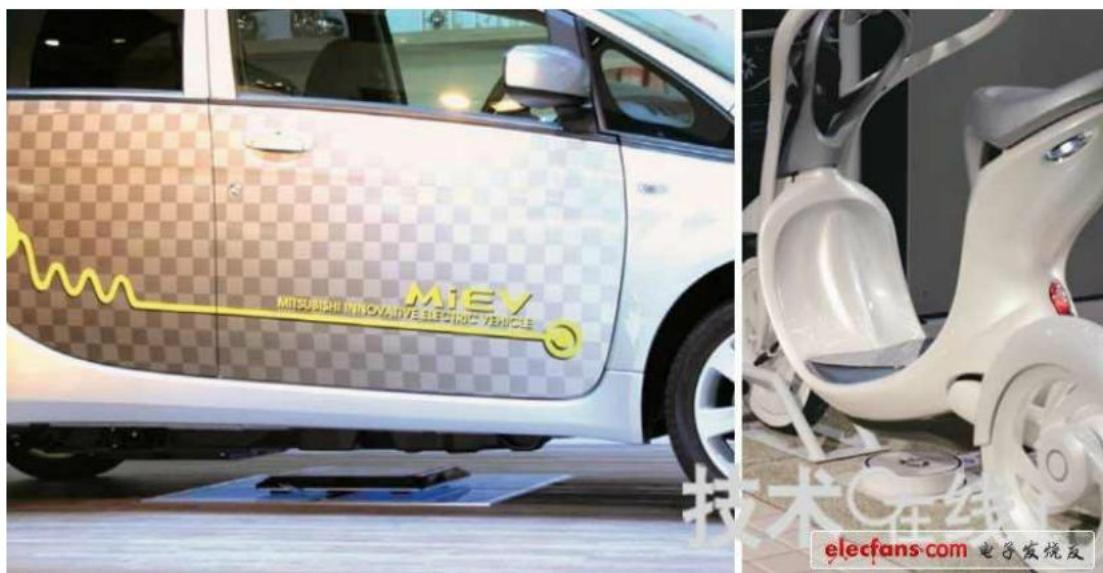
EV 的无线充电方面，采用磁共振方式的汽车厂商比较多。
