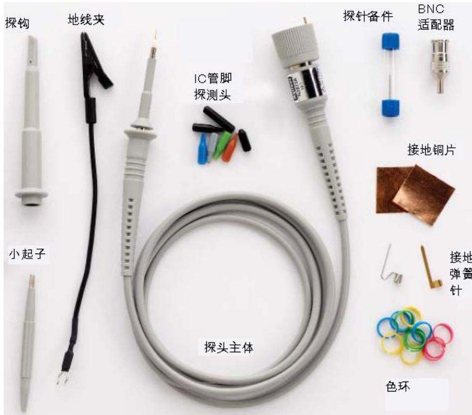
首先从地线说起。通常探头标配的 15cm 长的黑色的地线夹可以实现比较方便的地线连接，但是这么长的地线由于电感效应在测高频信号时会产生比较大的振荡，再有开关电源的场合还会耦合进很大的噪声。可能很多人都不知道，常用的 500MHz 的无源探头在使用这种长地线时带宽有个 200MHz~300MHz 就算不错了。所以如果要做高频测量，就需要换用相应的短地线，比如一些接地的弹簧针或弹簧片等。使用这种短的接地线所带来的一个问题是可能探测点附近找不到合适的接地点，而再引长线的话又会增加电感，所以通过相应的接地铜片把参考地引到探测点附近。由于铜片本身的横截面积比较大，所以其电感很小，可以提供一个比较理想的地参考点。以下是用弹簧接地片配合接地铜片进行测试的例子。
