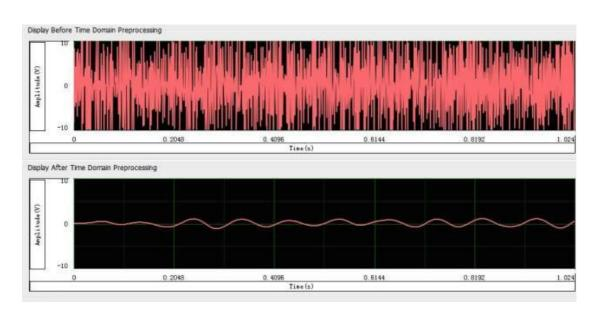
软件滤波功能可以通过 Labview、C#等语言编程实现,也可以直接使用现成的软件。这里我们使用 WebAccess/MCM 自带的软件滤波进行测试,将该软件安装在 MIC-1810 中(点击查看<u>产品硬件规格</u>),使用内置的滤波功能对现场干扰数据进行试验。
