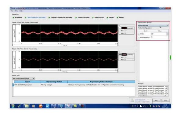
移动平均滤波有两个参数,Width:设置进行移动平均的窗口数量; moving average 为每一个点的移动平均权重,例如对 3 个点的平均值权重分配为 0.25/0.5/0.25 就是表示第 2 个数的权重是第 1 个数的 2 倍。
