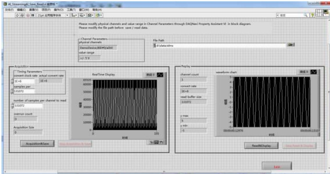
程序框图如下，主循环包括两个部分，上半部分为数据采集存储 TDMS，下半部分为读取 TDMS 数据和回放分析。
