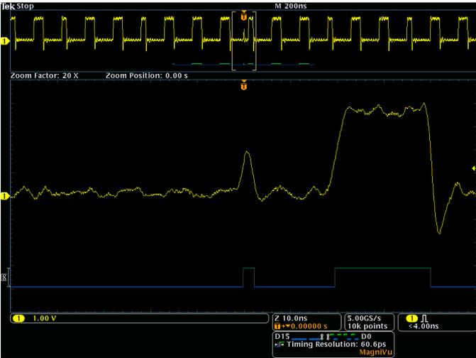
MagniVu 超高分辨率记录提供了 60.6 ps 的定时分辨率，可以在数字波形上进行关键定时测量。
