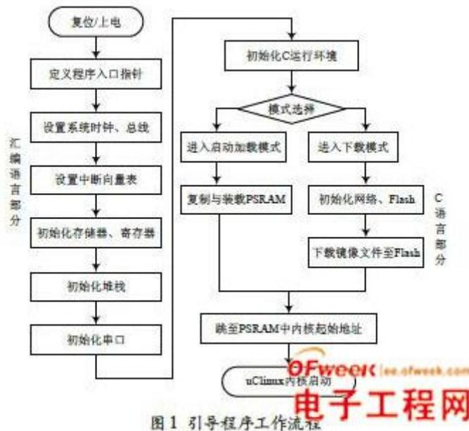
图 1 引导程序工作流程
