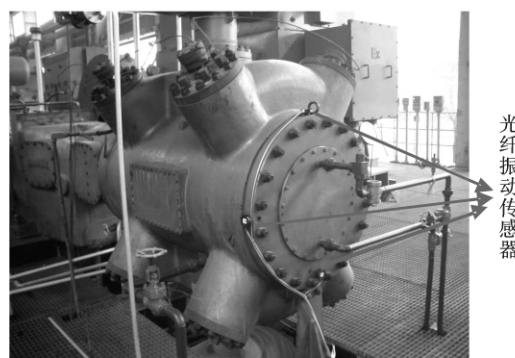
图6 光纤振动传感器安装照片
