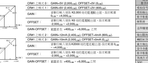
上列表示電壓輸出模式之電壓與數字值之 D/A 轉換特性曲線, 使用者可依據實際應用需要調整轉換特性曲線, 調整時以改變 OFFSET 值 (CR#18 ~ CR#19) 及 GAIN 值 (CR#15 ~ CR#18) 來進行.
