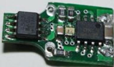
超级迷你的5V转4.2V恒流充电板
