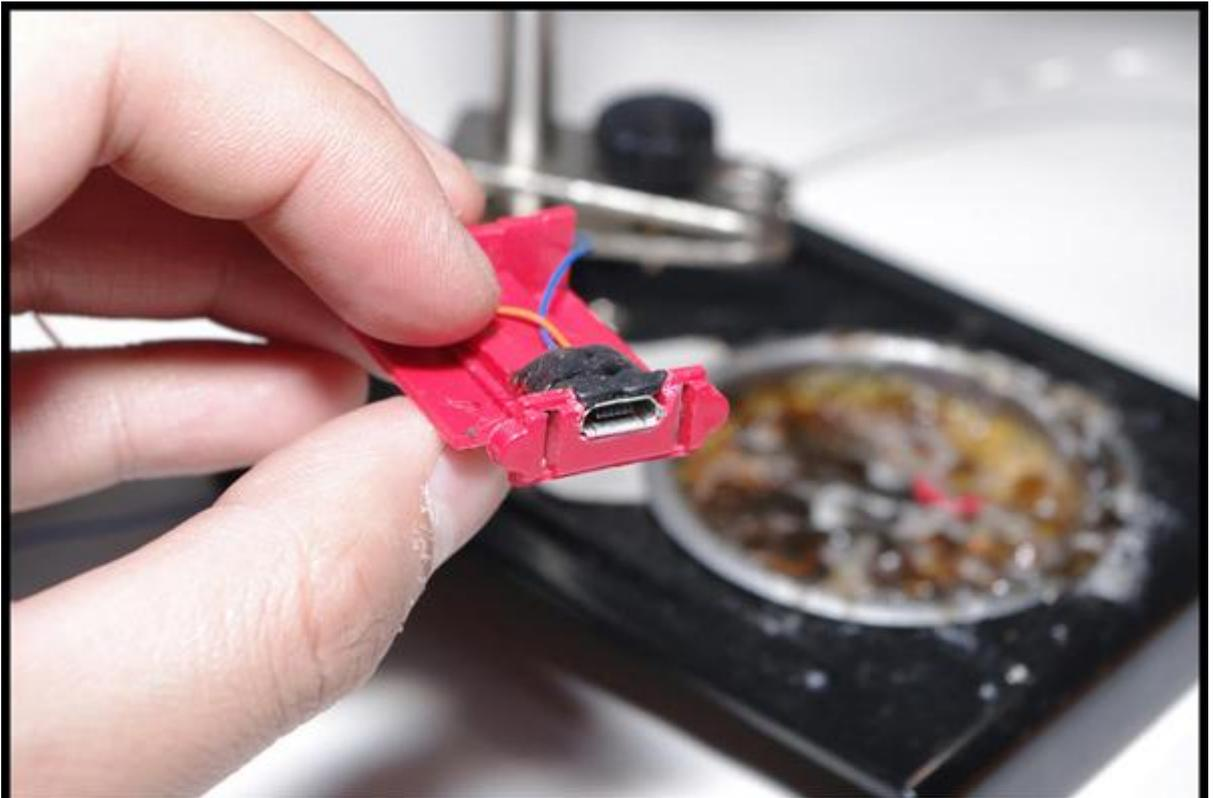
这是破台灯原来的后口,直接接市电的,锂电池充电不敢马虎,所以干脆就外置充电器吧,充电口直接用5vusb口吧,为了通用性方便,直接弄成Micro USB这样老爸老妈就直接可以用手机充电器数据线充电了
