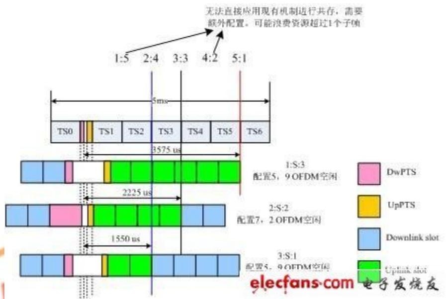
由于 TD-S 的常规时隙和特殊时隙的配比是固定的，而 TD-L 的特殊时隙中 DwPTS、GP 和 UP 的长度支持 9 种灵活配比。TD-LTE 特殊时隙的配置情况如下表所示：
