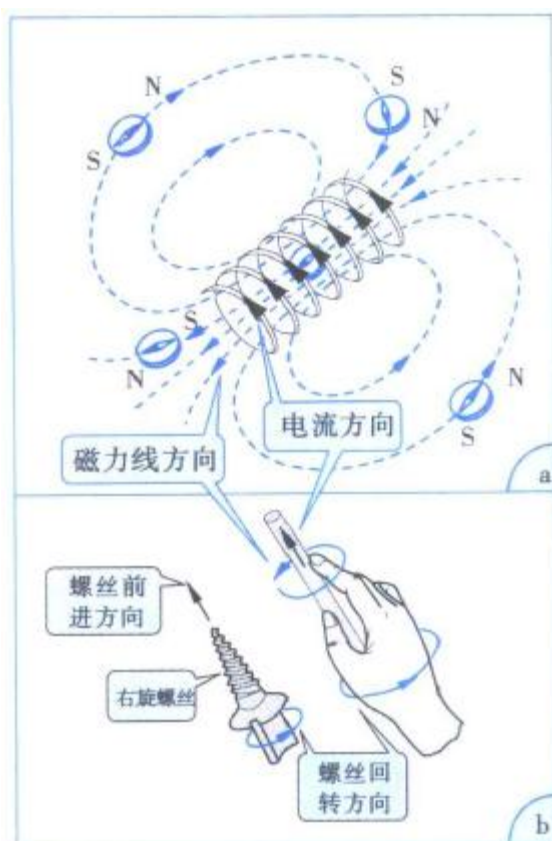
图 4.10 线圈电流、磁力线的方向
