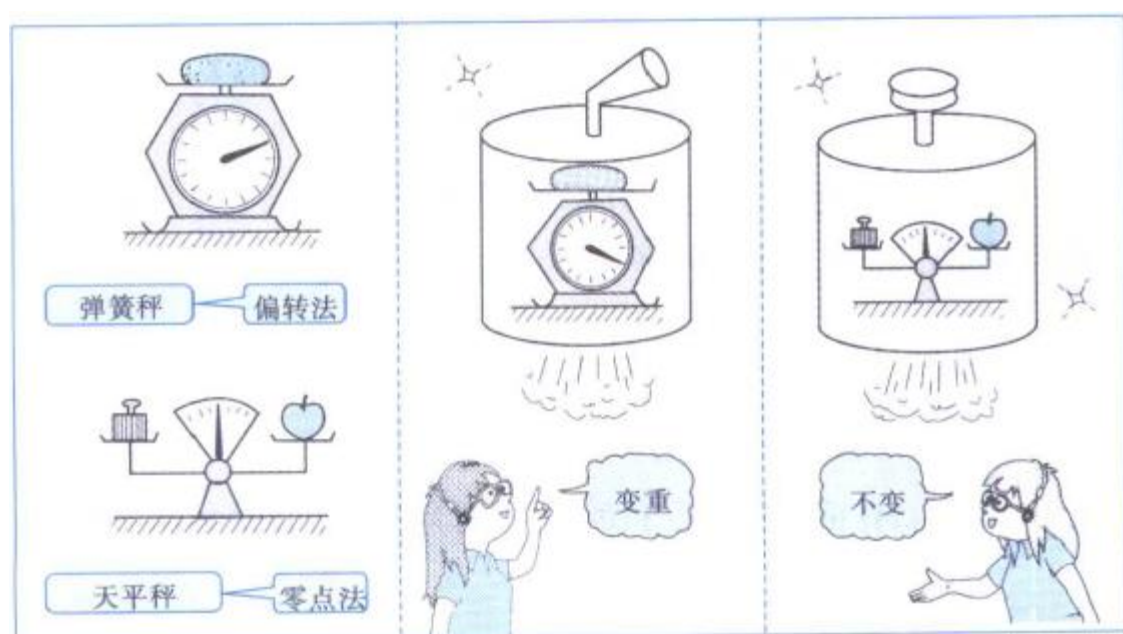
图 3.15 偏转法和零点法的比较
