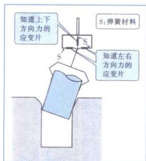
图 1.2 用应变片检测力
