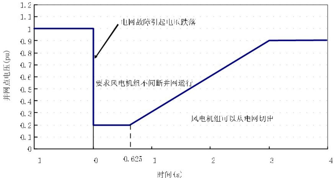
图 1 风电场低电压穿越要求的规定
