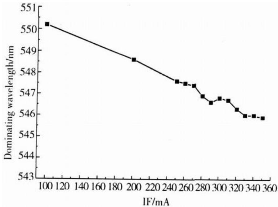
图 3：主波长和正向电流的关系
