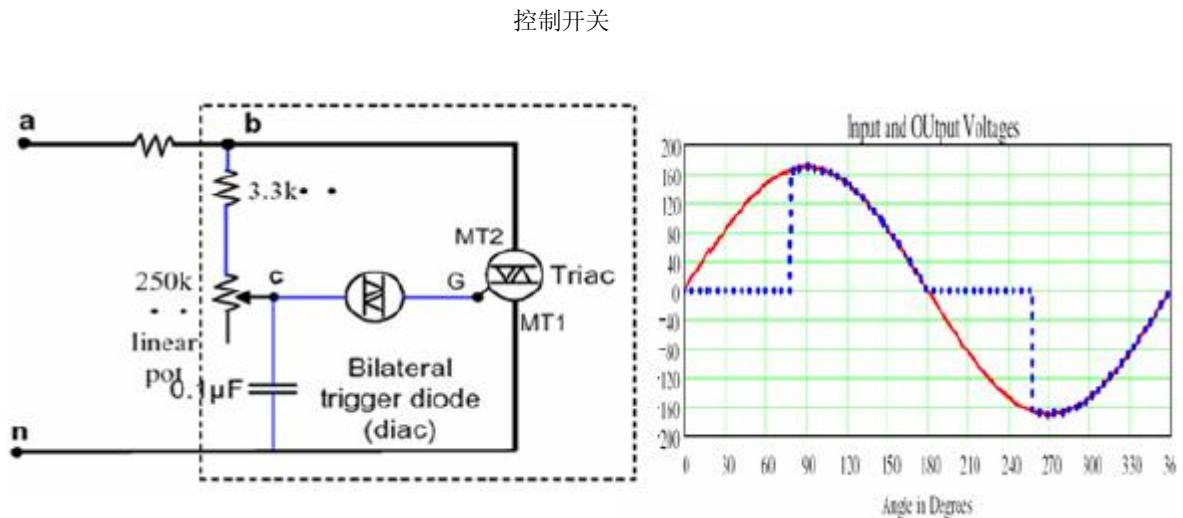
图 9：可控硅调光的电路图和波形图
