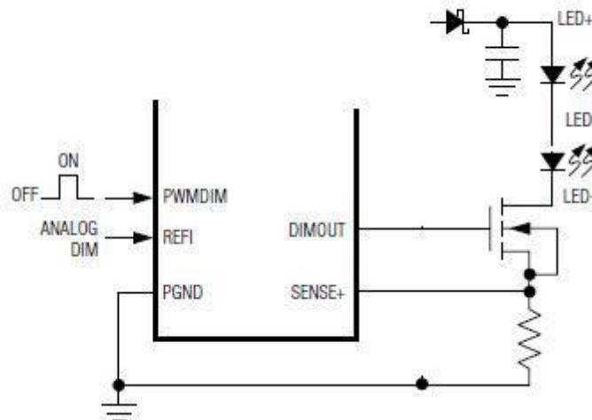
图 8：用 PWM 信号快速通断 LED 串
