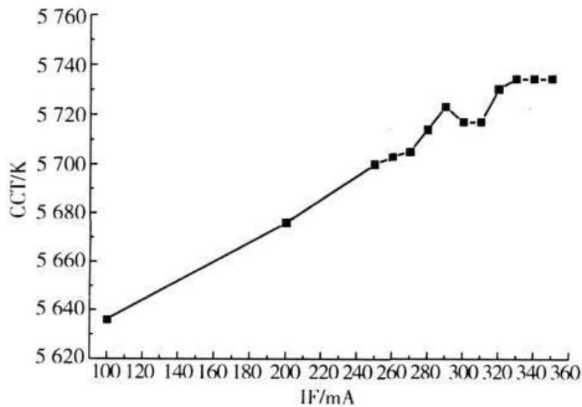
图 4：白光 LED 的色温和正向电流的关系
