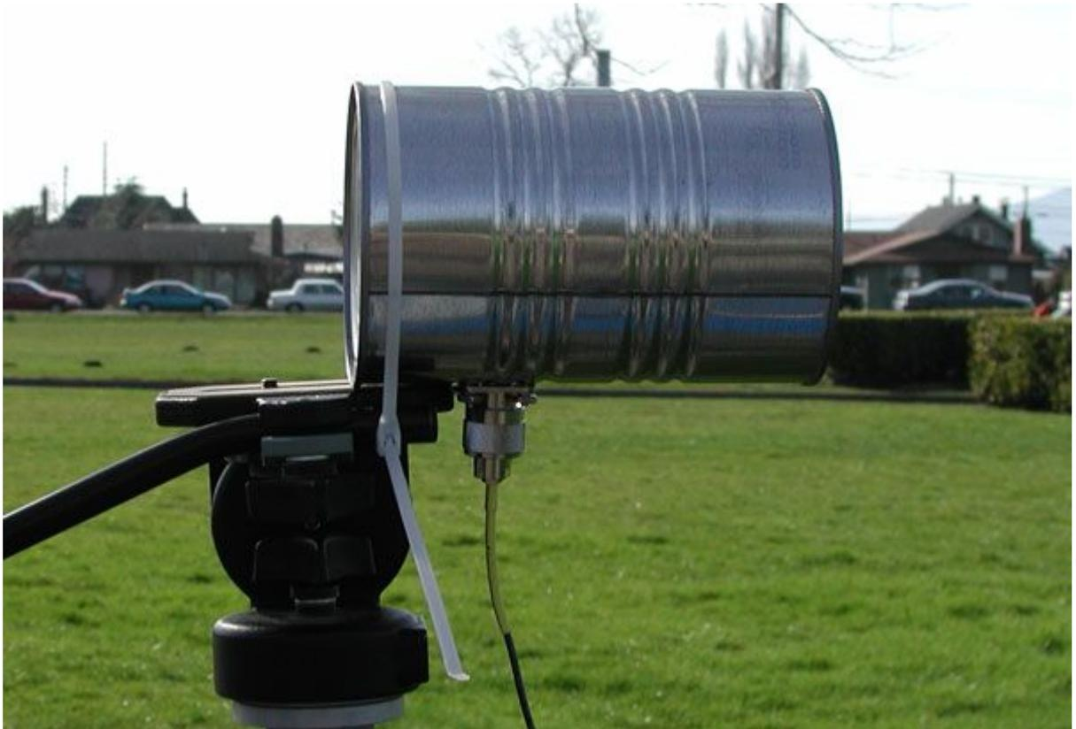
把罐子安装到支架上。尽量避免在罐内有其它东西，固定用的螺丝螺母尽量少。
