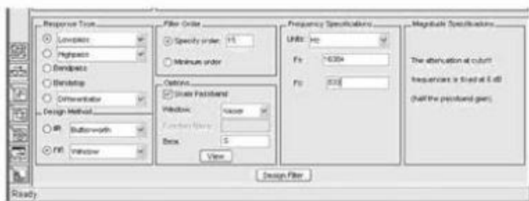
图 4 FDATool 的滤波器设计界面
