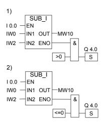
在输入 I0.0 的信号状态为 1 时会激活 SUB\_I 框。如果输入字 IW0 的值大于输入字 IW2 的值,则数学运算 IW0 - IW2 的结果大于 0。如果 EN 的信号状态为 1 (已激活),而在执行指令期间发生错误,则 ENO 的信号状态为 0。
