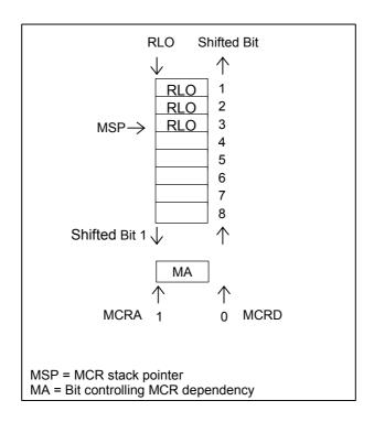
MCR<指令采用 RLO 的信号状态,并将它复制到 MCR 位中。
