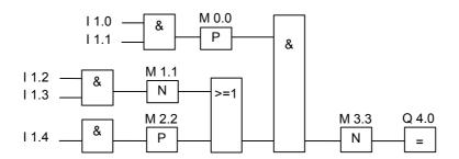
沿存储位 M3.3 存储先前 RLO 的信号状态。
