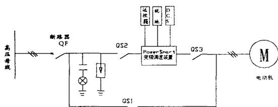
变频器采用哈尔滨九洲电气股份有限公司生产的 PowerSmart 高压大功率变频器,其中 QF 为高压断路器, QS1 为电动机工频隔离开关, QS 2、QS3 为电动机变频隔离开关, QS1、QS2 与 QS3 互锁。从系统的原理图中可看出,进行变频改造对原系统改动较小,可在较短时间内完成改造方案, QS1 的加入可使变频在有故障的情况下工频旁通。
