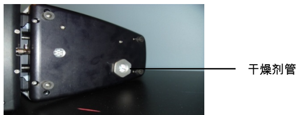
图 15. Cary 630 FTIR 底部的干燥剂管位置
