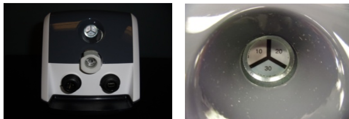
图 14. Cary 630 FTIR 后部的湿度指示器（左）和特写（右）
