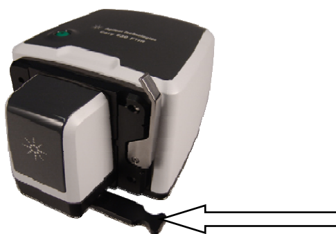
图 12. 连到 Cary 630 FTIR 的漫反射附件。样品架推入附件右下方的插槽中。
