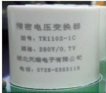
图 9 TR1102-C 型电压变换器
