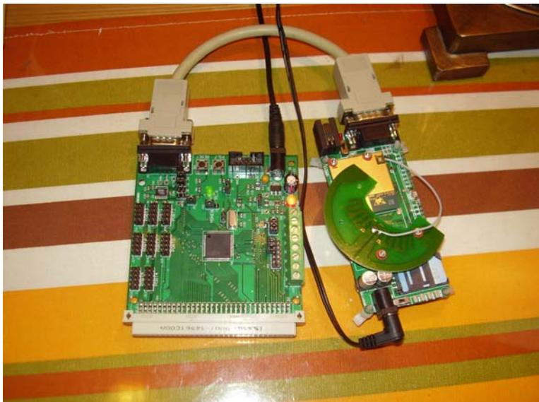
图20 数据采集与通信硬件电路板实物图
