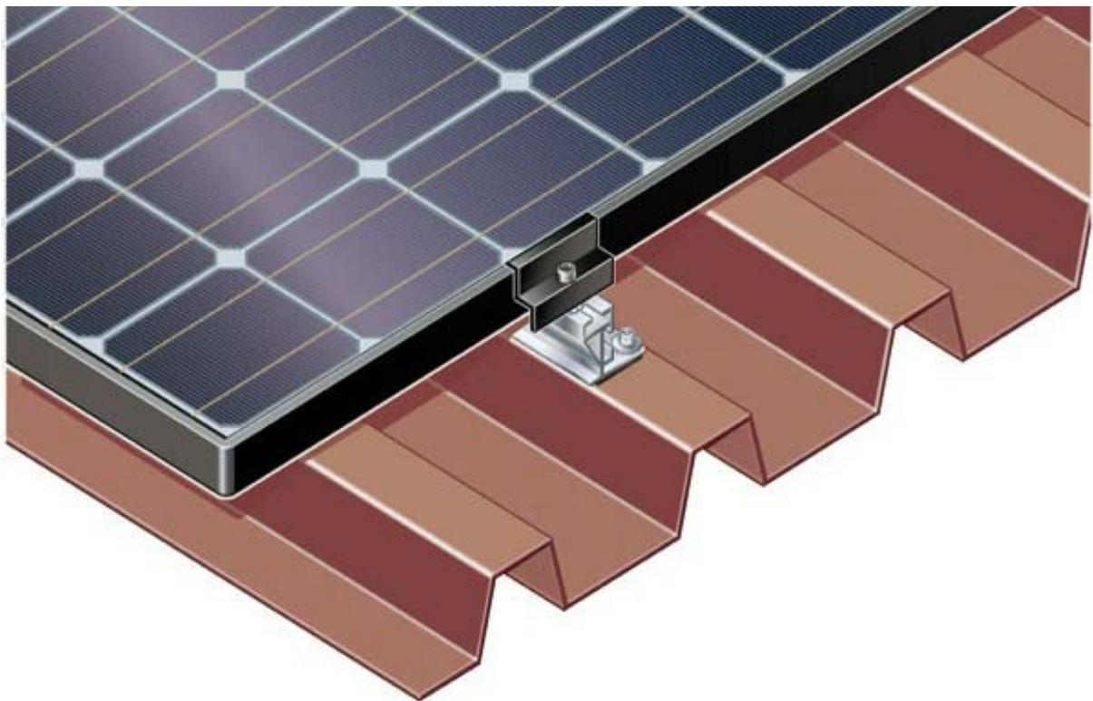
图 1-4 太阳能方阵与屋顶结合端面点构件图 2
