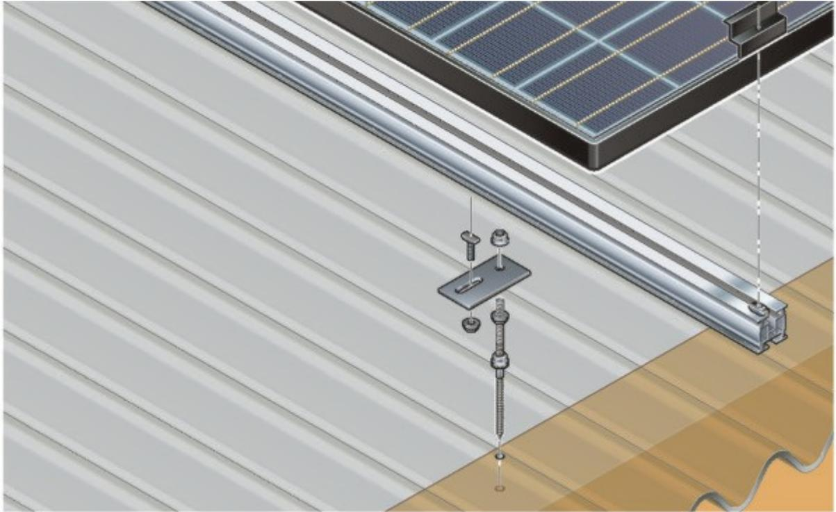
图 2-3 太阳能方阵支持件与屋顶结合方式示意图 1
