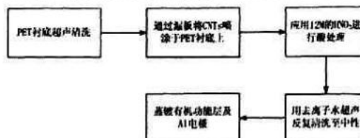
图 5 应用 CNTs 作为阳极的柔性 OLED 工艺流程图
