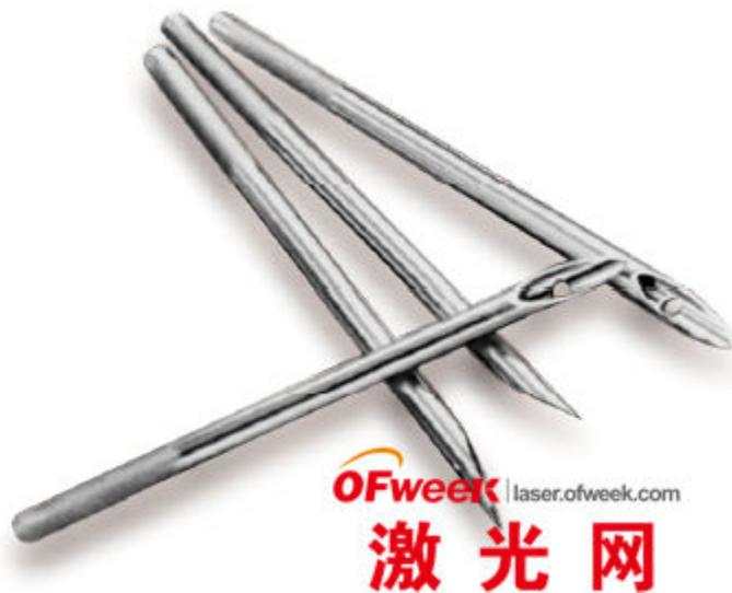
用激光对医用活检穿刺针进行切割和钻孔
