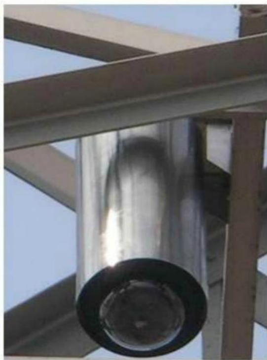
拍摄时摄像机伸出防护罩
