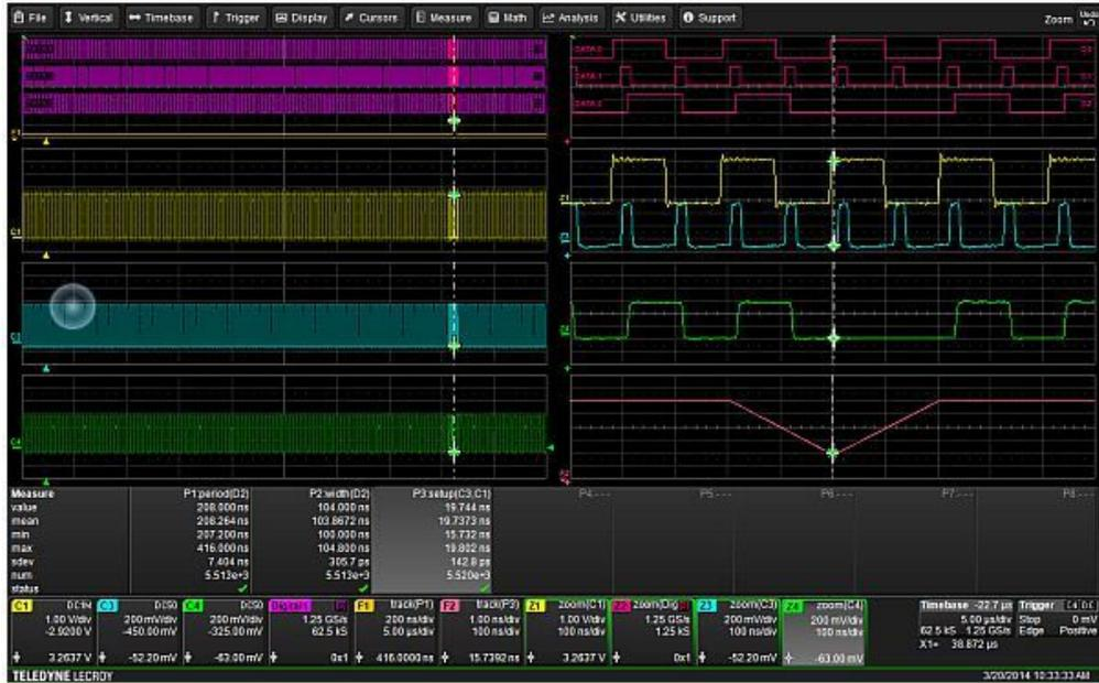
图 4: 使用 D2 周期的踪迹定位采集记录中的长周期。缩放最大周期可以方便地观察数字和模拟轨迹中的细节。
