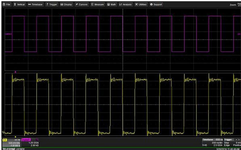
图 2: 数字轨迹(顶部)和模拟波形的比较。数字轨迹幅度用 1 或 0 表示，判断依据是数字输入端的电压是高于还是低于用户设定的逻辑阈值。模拟轨迹被分解为 4096 个(12 位)幅度等级中的任意一个。
